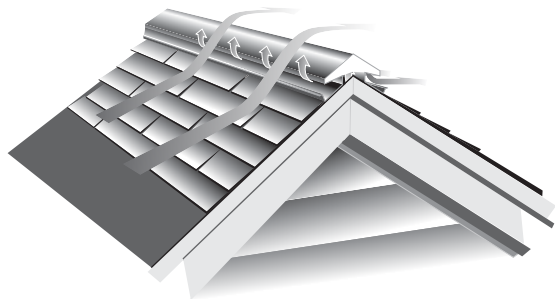
Figura 7-20: Una ventilación CertainTeed de cumbrera con deflector crea un área de baja presión a los dos lados de la ventilación de cumbrera. Literalmente levanta el aire y lo saca del ático por ambos lados de la ventilación.
