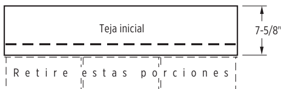
Figura 11-6: Cree tejas iniciales de 7 5/8" (193 mm) de altura.
