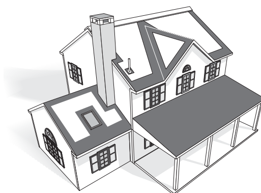
Figura 7-6: Las zonas sombreadas son los lugares que WinterGuard o Grace Ice & Water Shield ayuda a proteger del agua de deshielo que sale de la formación de hielo.
