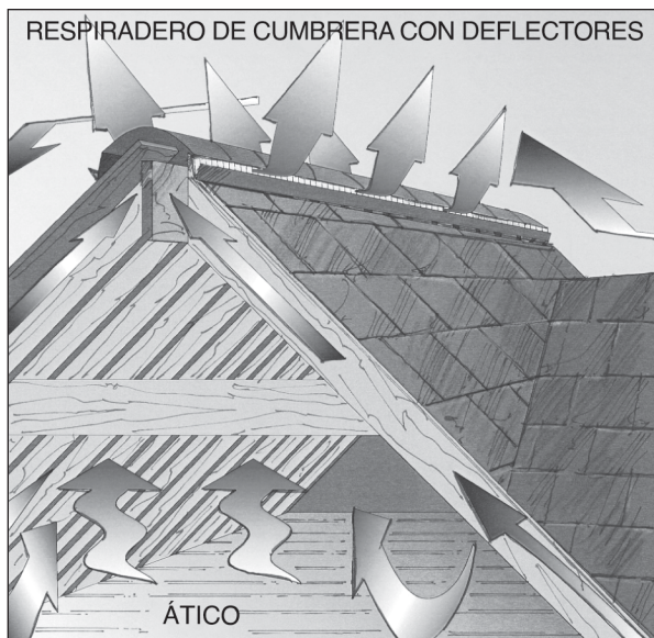
Figura 7-12: En los techos en forma de “L” o de “T”, las ventilaciones deben atravesar las cumbreras largas y cortas siempre que las áreas del ático estén abiertas entre sí. Si las alturas del techo varían en más de 3 pies (91.5 cm), las ventilaciones deben ubicarse junto a la cumbrera más alta o se debe separar el ático.
