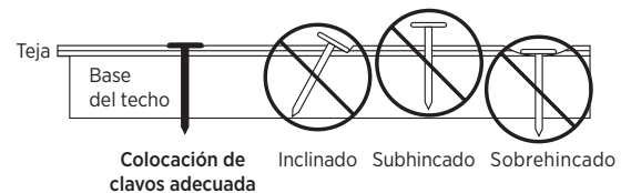
1-3: Colocación de clavos correcta e incorrecta.
