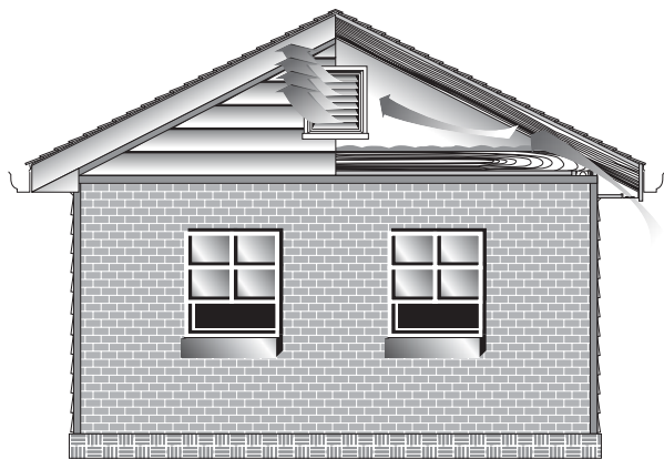
Figura 7-17: La celosía del hastial, como ventilación de salida, deja que el aire innecesario salga del ático. Se ubican en los extremos del ático.
