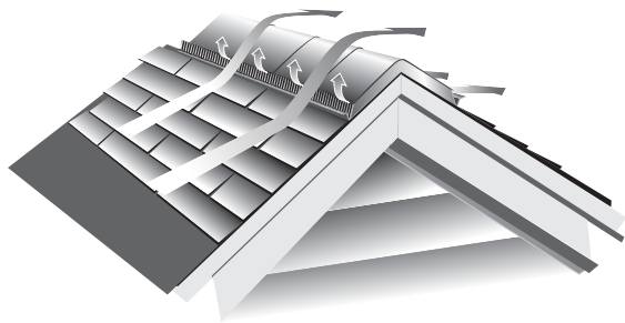
Figura 7-23: Una ventilación con un deflector externo “empuja” aire desde el ático por ambos lados de la ventilación.
