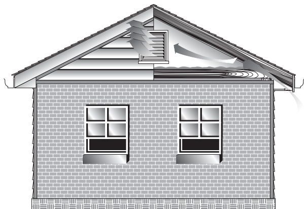
Figure 7-17: La persienne de pignon, un évent de sortie, permet à l'air indésirable de s'écouler hors du grenier. Ces événements sont situés aux extrémités du comble.
