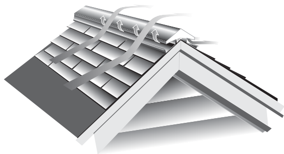
Figure 7-20 : L'évent de faîtage à déflecteur de CertainTeed crée une zone de basse pression sur les deux côtés de l'évent de faîte. Il soulève littéralement l'air pour le propulser hors du comble des deux côtés de l'évent.
