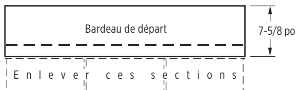
Figure 11-6 : Fabriquez des bardeaux de départ de 7-5/8 po de haut.
