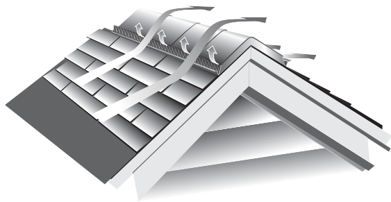
Figure 7-23 : L'évier à déflecteur externe aspire l'air par les deux côtés de l'évier.
