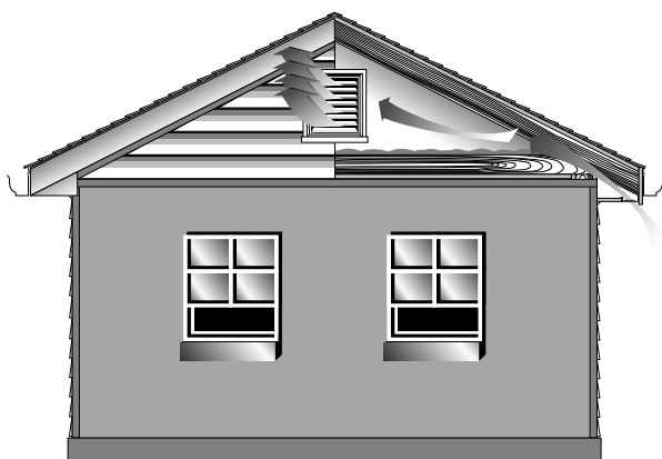
Figure 7-17 : L'événement de pignon laisse sortir l'air du comble. Ces événements sont situés aux extrémités du comble.
