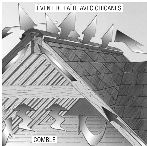
Figure 7-12 : Dans les toits en L et en T, les événements devraient longer le grand et le petit faîtes, si les aires communiquent entre l'un et l'autre. Si la hauteur du toit varie de plus de 3 pieds (914 mm), les événements devraient être placés seulement le long du plus grand faîte ou les combles devraient être séparés.
