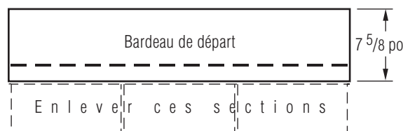
Figure 12-5 : Fabriquer des bardeaux de départ de 7 5 / 8 po (193 mm) de hauteur.
