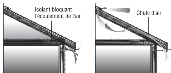
Figure 7-10 : (à gauche) Éviter d'installer l'isolant par-dessus la soffite/la zone de prise d'air de l'avant-toit, car cela pourrait faire obstacle à l'entrée d'air dans le comble.
