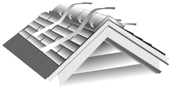
Figure 7-23 : L'évent à chicane externe aspire l'air par les deux côtés de l'évent.
