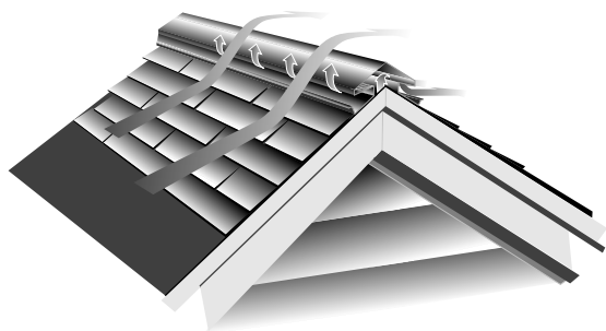
Figure 7-20 : L'évent à chicane CertainTeed Ridge Vent crée une zone de basse pression sur les deux côtés de l'évent de faîte. Il soulève littéralement l'air pour la propulser hors du comble des deux côtés de l'évent.
